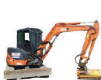
ESCAVATORE CON TRINCIA
