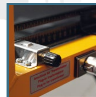
Nuovo sistema di blocco dell'arco di taglio, per facilitarne il trasporto
