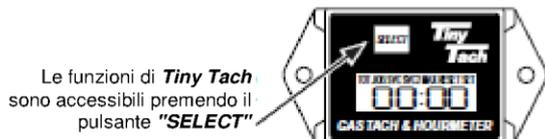
Per controllare i parametri configurati premere il pulsante "SELECT" fino a che l'icona del parametro selezionato nella parte superiore dello schermo cambia (tra "TOT", "JOB" e "F"), quindi rilasciarlo. Ogni parametro verrà visualizzato per circa 15 secondi, poi lo schermo tornerà alla modalità iniziale, "TOT"
