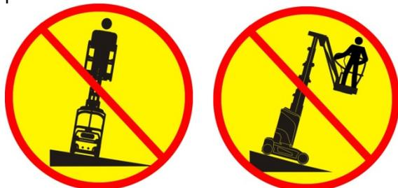
NON affidarsi all'allarme antiribaltamento come indicatore di inclinazione. L'allarme acustico antiribaltamento si attiva sul telaio e nella piattaforma quando la macchina è in pendenza.
