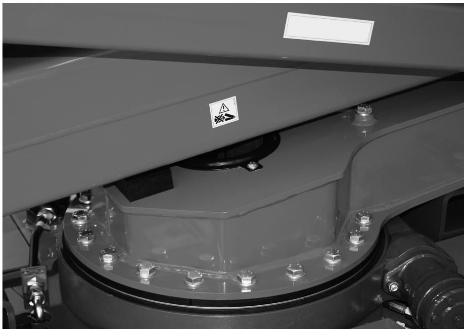
Fig. 115 Pericolo cesoiamento su macchina 2
