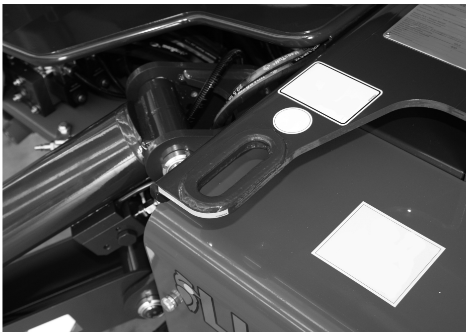
Fig. 198 Punti di sollevamento con funi o catene
