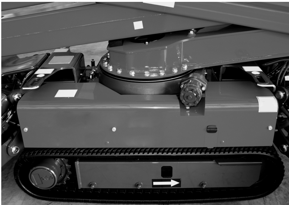
Fig. 197 Punti di sollevamento con forche
