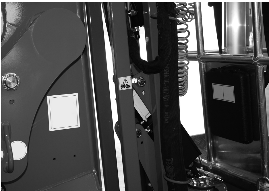
Fig. 114 Pericolo cesoiamento su macchina 1
