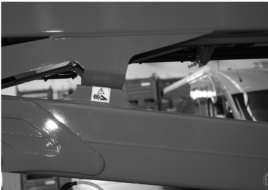
Fig. 116 Pericolo cesoiamento su macchina 3
